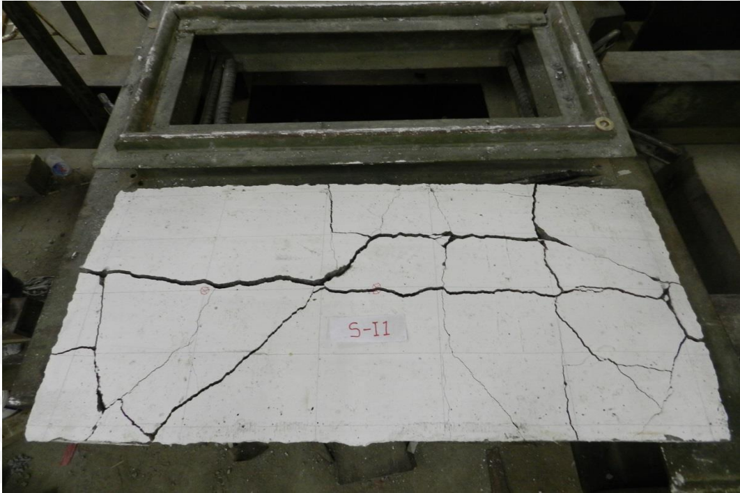
Gambar 4. 13 Pola Retak Bagian Bawah Pada Plat S-I1
