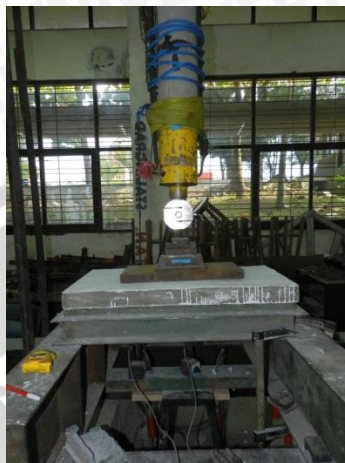
Gambar 4. 4 Pembebanan Pada Plat
