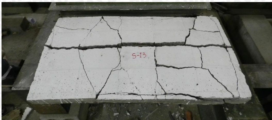
Gambar 4. 15 Pola Retak Bagian Bawah Pada Plat S-I3
