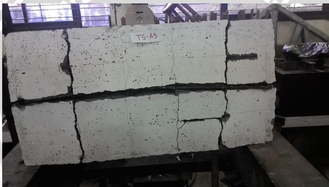
Gambar 4. 16 Pola Retak Bagian Bawah Plat TS-A3
