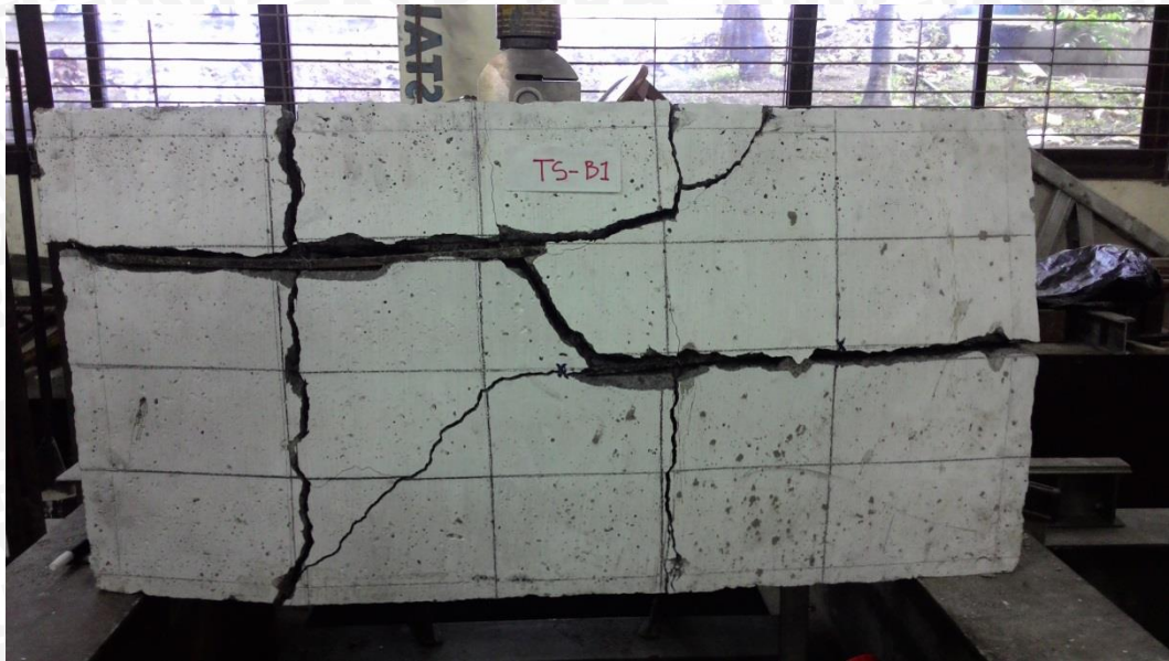
Gambar 4. 17 Pola Retak Bagian Bawah Plat TS-B1
