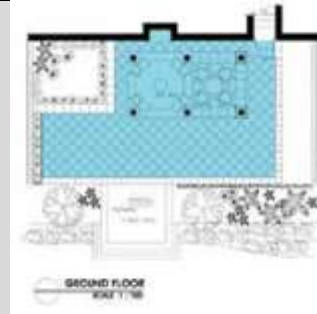
Bentuk bangunan persegi, dengan peletakan inlet dan outlet pada kedua sisi. Terdapat kolam sebagai pendingin.
