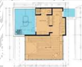
Bentuk bangunan persegi, dengan peletakan inlet dan outlet pada kedua sisi. Terdapat kolam sebagai pendingin.
