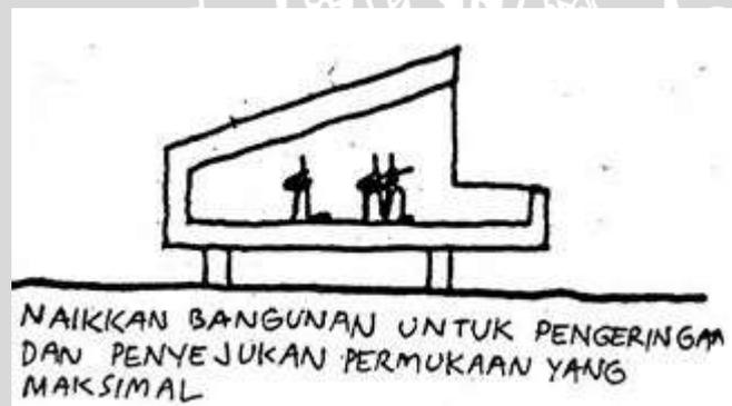
**Gambar 2.20** Konstruksi bangunan panggung untuk pengeringan dan penyejukan permukaan yang maksimal
