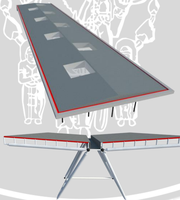
Gambar 4.55 Sistem talang pada struktur atap
