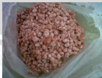
Gambar 1.1 Pupuk NPK Phonska yang menggumpal ( caking )
