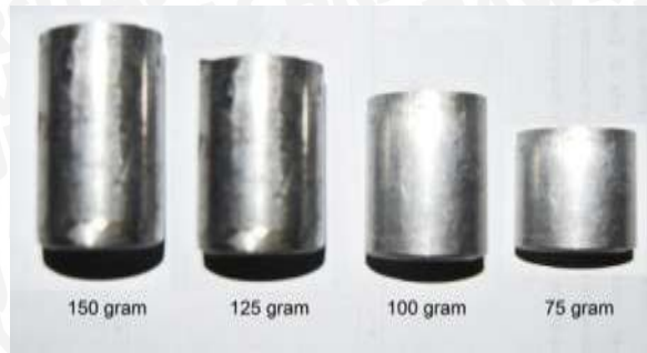
Gambar 3.8. Variasi Beban Katup Limbah (sumber : dokumentasi)
