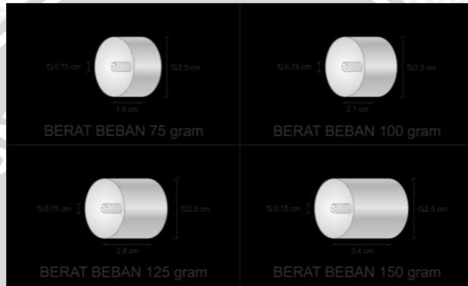
Gambar 3.9. Dimensi Variasi Beban Katup Limbah (sumber : dokumentasi)
