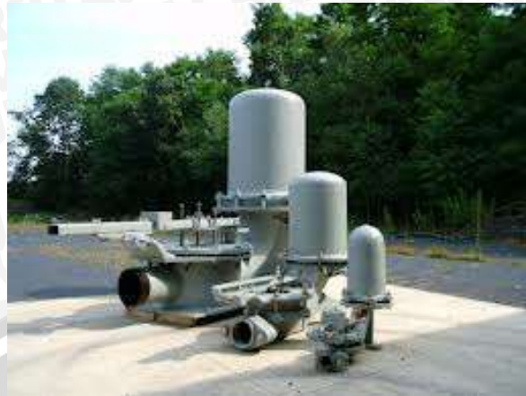
Gambar 2.11. Contoh Varian Tabung Udara Pada Pompa Hidram Pabrikasi (sumber : www.africantechologyforum.org diunduh 11 November 2014)
