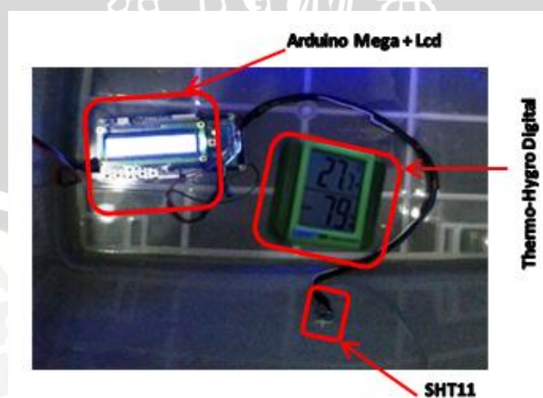
Gambar 5.1 Rangkaian Pengujian Sensor SHT11 (Perancangan)
