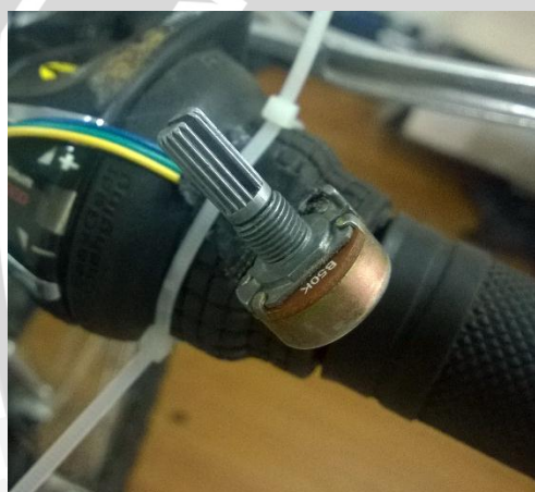
Gambar L2.2: (a) Variabel potensiometer (b) Baterai VRLA 4 buah
