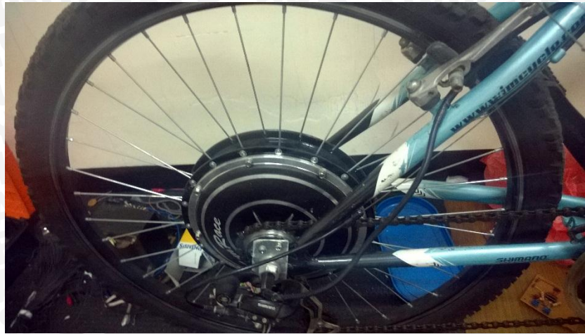
Gambar L2.4: Motor BLDC terpasang pada roda belakang
