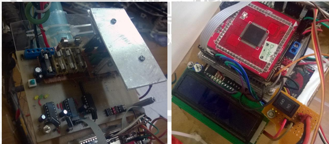
Gambar L2.6: , Inverter tiga fasa, Mikrokontroler dan LCD
