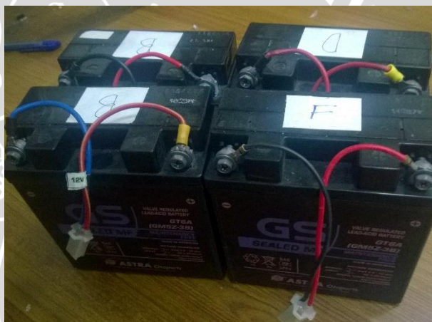
Gambar L2.2: (a) Variabel potensiometer (b) Baterai VRLA 4 buah
