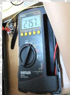
Gambar 4.14. Pengukuran Tegangan Penerima dengan Multimeter
