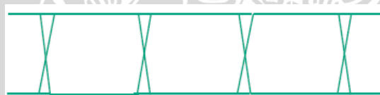
Gambar 2.15. Eye Diagram Ideal Dengan Finite Rise dan Fall Time (Sumber: Breed, 2005)
