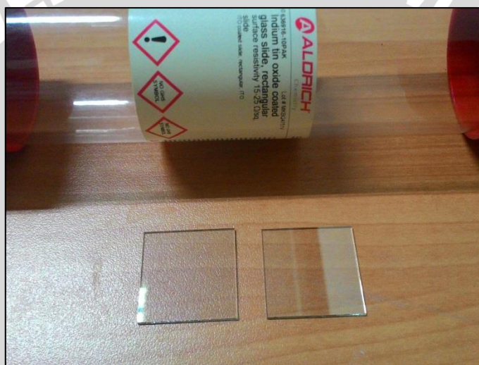
Gambar 4.3 Kaca TCO yang Siap Digunakan dengan Dimensi 2,5 \times 2,5 \text{cm}^2
