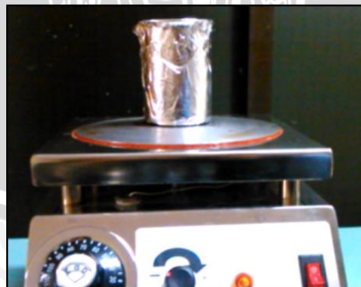
Gambar 4.5 Proses Homogenisasi Klorofil Dengan Pelarut
