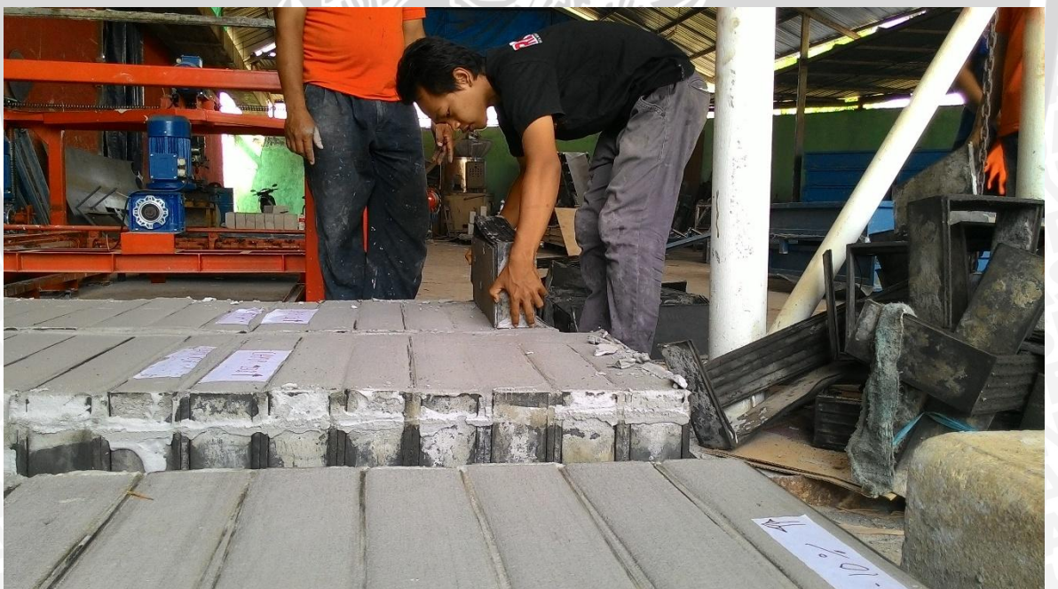
Gambar: Pelepasan bekisting benda uji
