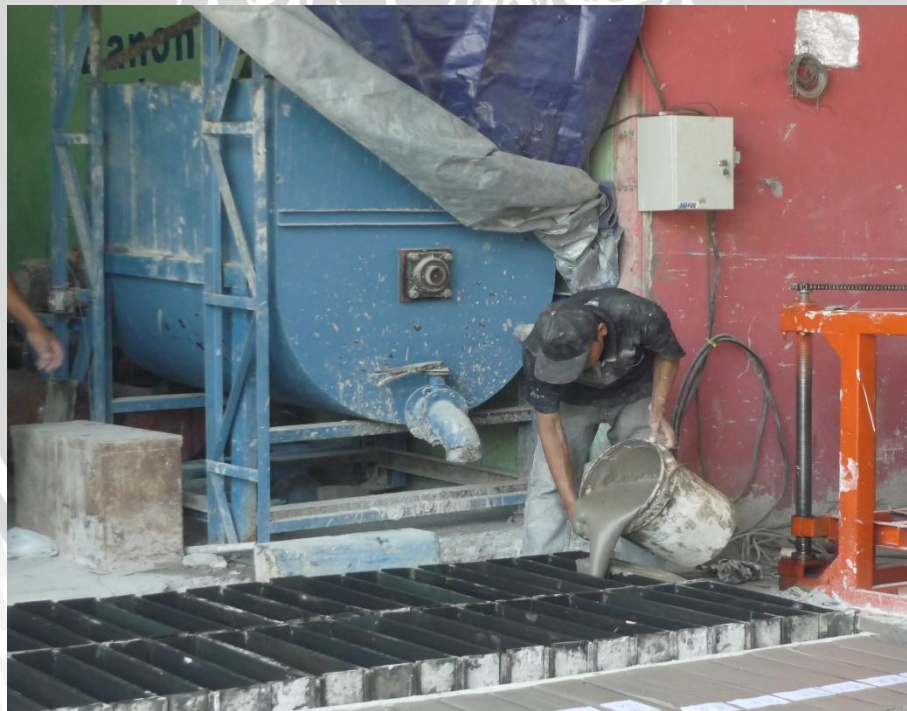
Gambar: Pencetakan benda uji
