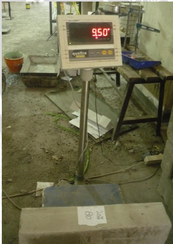
Gambar: Penimbangan benda uji
