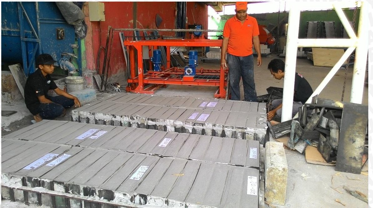
Gambar: Benda uji setelah melalui proses pencetakan
