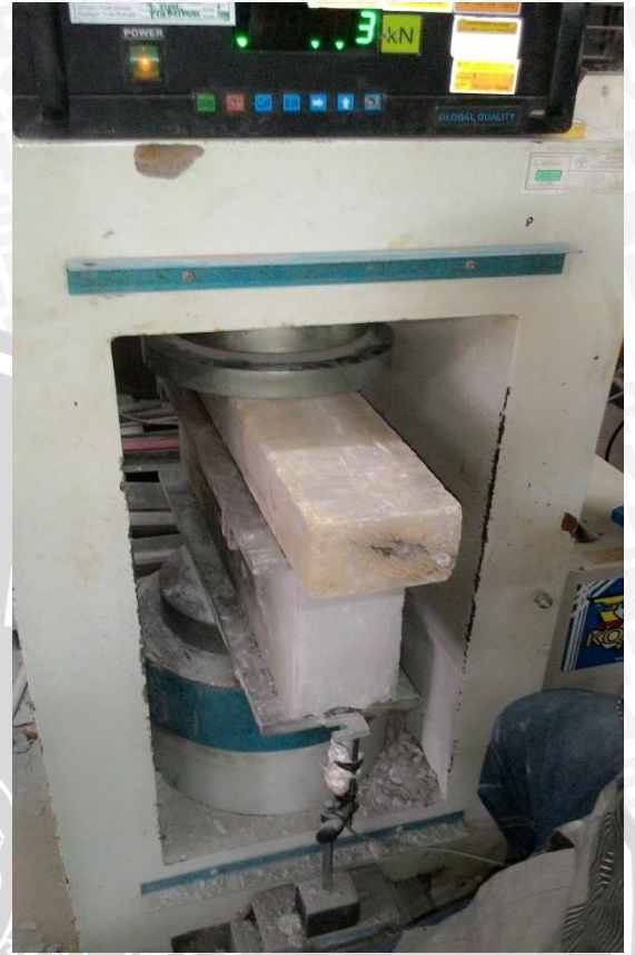
Gambar: Pengujian kuat tekan dan tegangan-regangan benda uji
