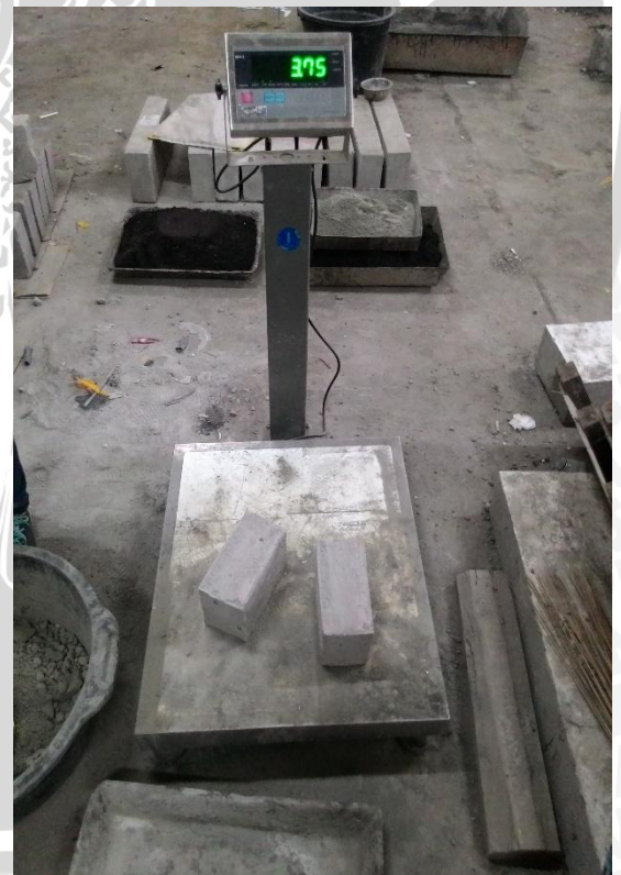
Gambar: Penimbangan benda uji
