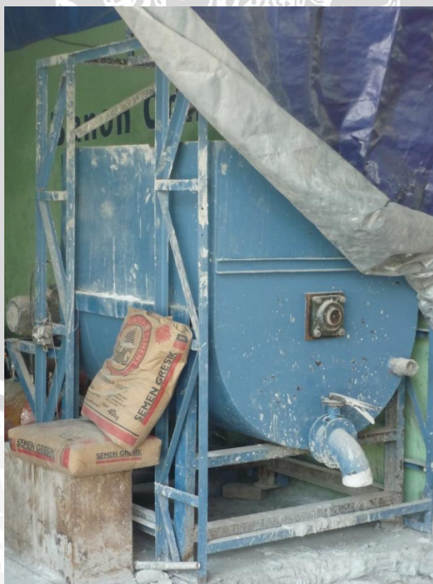
Gambar Mixer pembuat bata beton ringan
