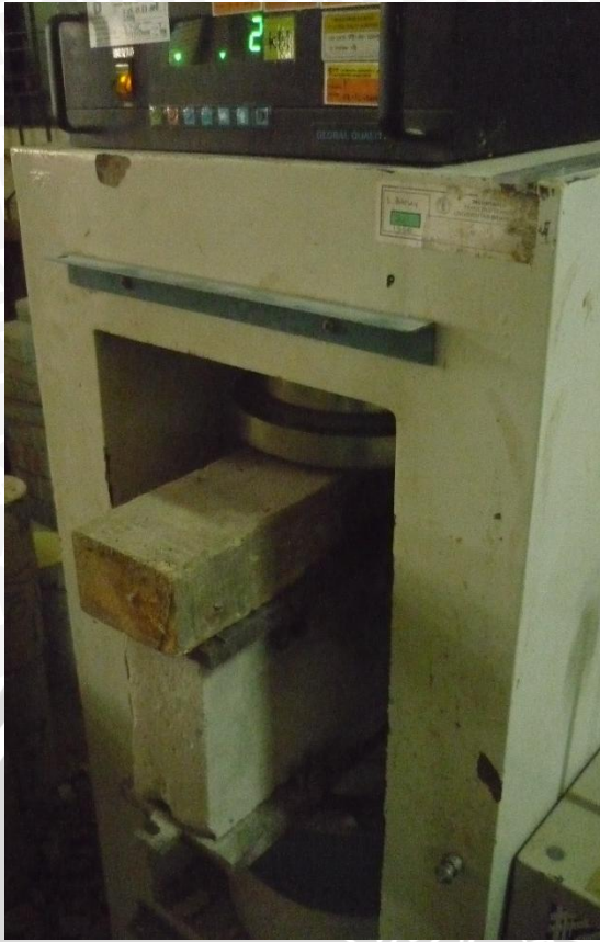
Gambar: Pengujian kuat tekan dan tegangan-regangan benda uji
