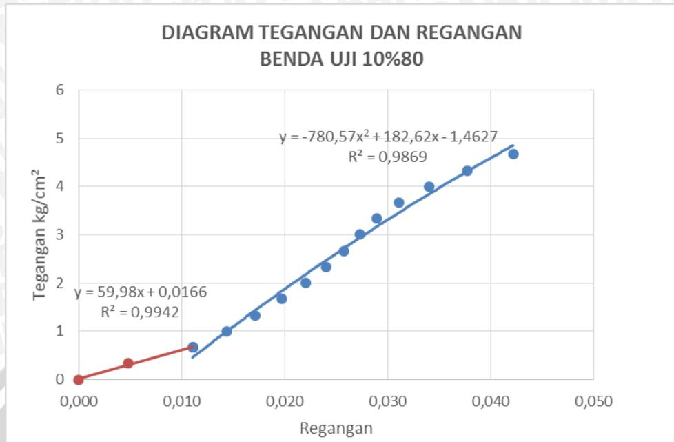
**Gambar 4.4.** Diagram tegangan-regangan benda uji 10%80
