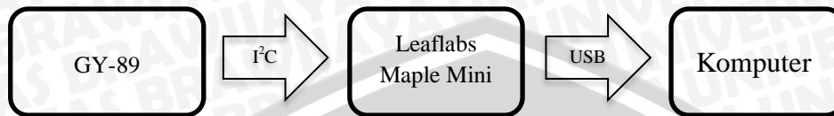
Gambar 5.3 Diagram Blok Pengujian Antarmuka Modul Sensor GY-89.
