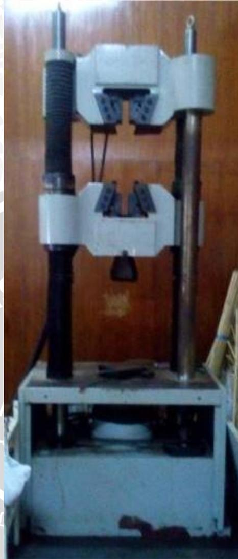
Gambar 3.3 Mesin Uji Tarik
