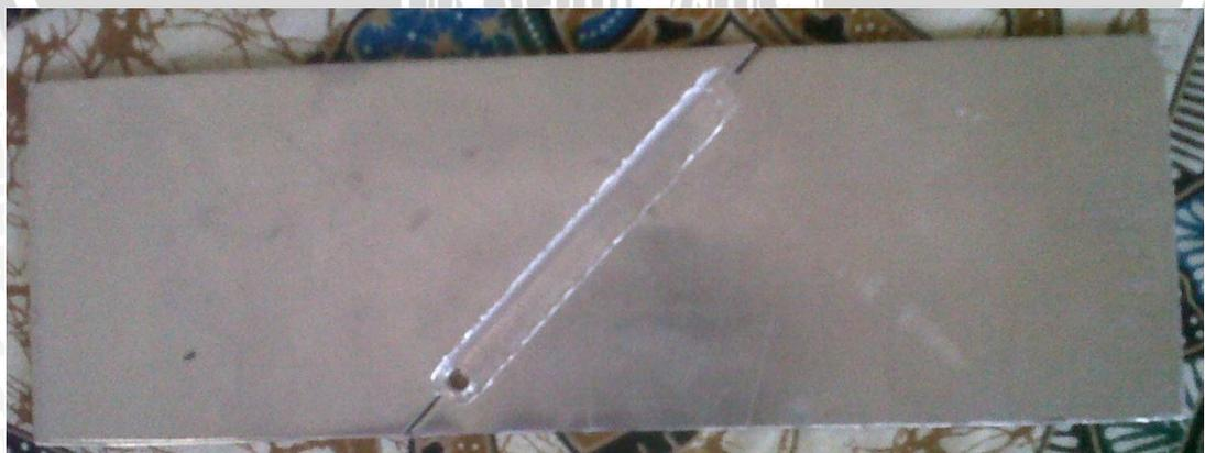
Gambar 3.9 Benda Kerja Setelah di Las
