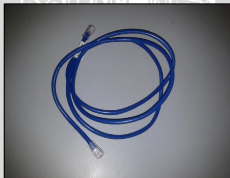
Gambar 4.7. Kabel UTP RJ-45
