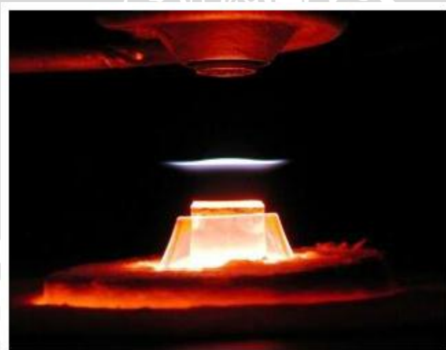
Gambar 2.4 Nyala Api pada Counterflow Diffusion Burner
