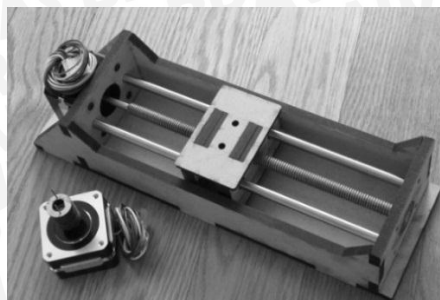
Gambar 2.1 Aktuator Linier menggunakan Leadscrew Sumber: DNC Labs, 2013
