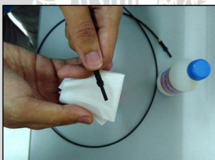
Gambar 4.14 Pembersihan POF dengan Alkohol 95%
