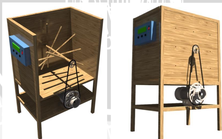
Gambar 4.2 Rancangan Kotak Fermentasi
