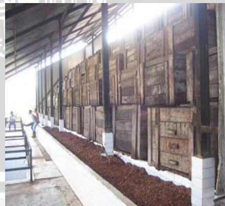
Gambar 2.2 Peti Kayu dan Susunan Peti Fermentasi
