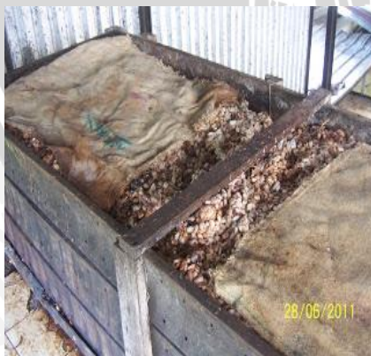
Gambar 2.2 Peti Kayu dan Susunan Peti Fermentasi
