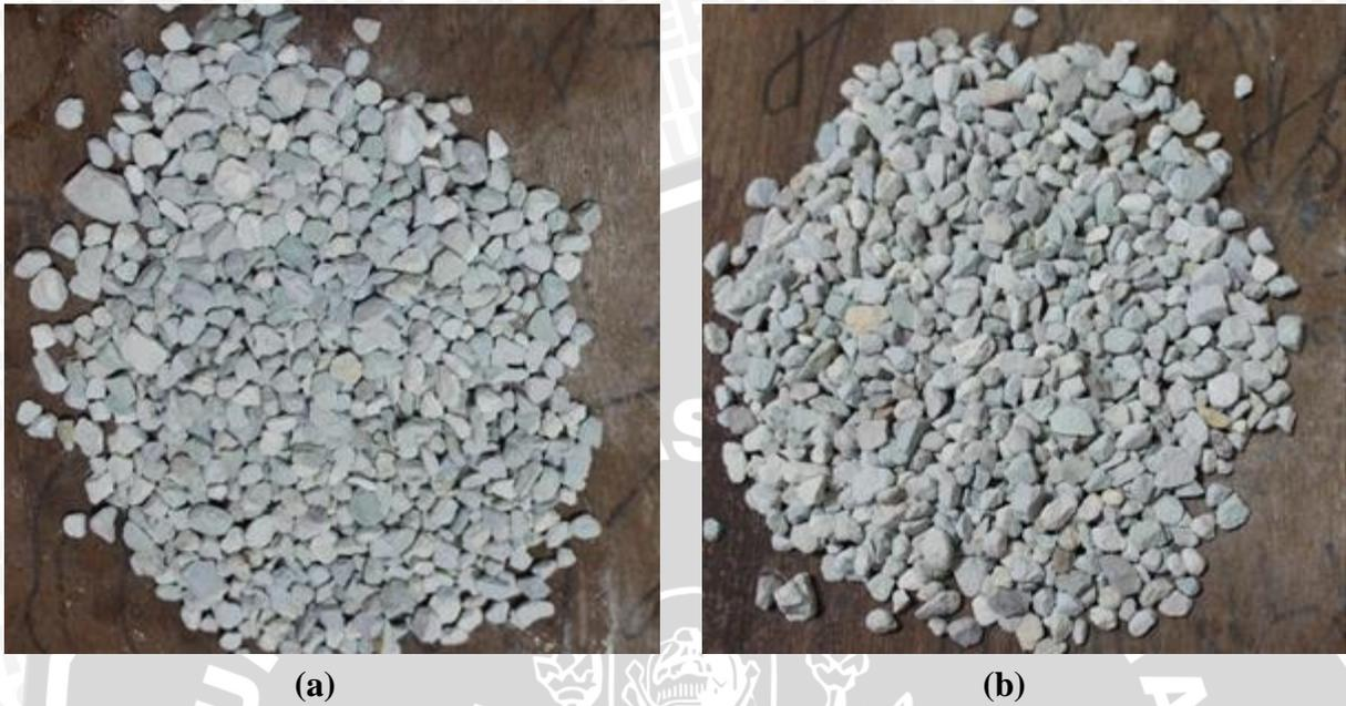
Gambar 4.3 a) Zeolit sebelum purifikasi, b) Zeolit setelah purifikasi
