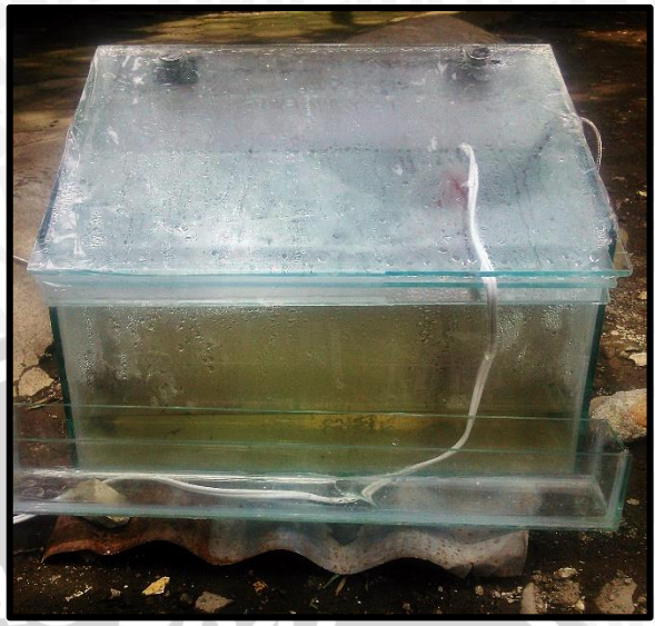
Rumah Evaporator Tampak Depan
