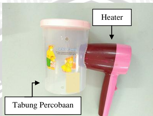
Gambar 4.15. Persiapan Pemanas Udara dan Tabung Percobaan
