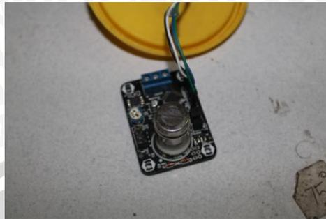
Gambar 3.13 Sensor Gas Karbondioksida
