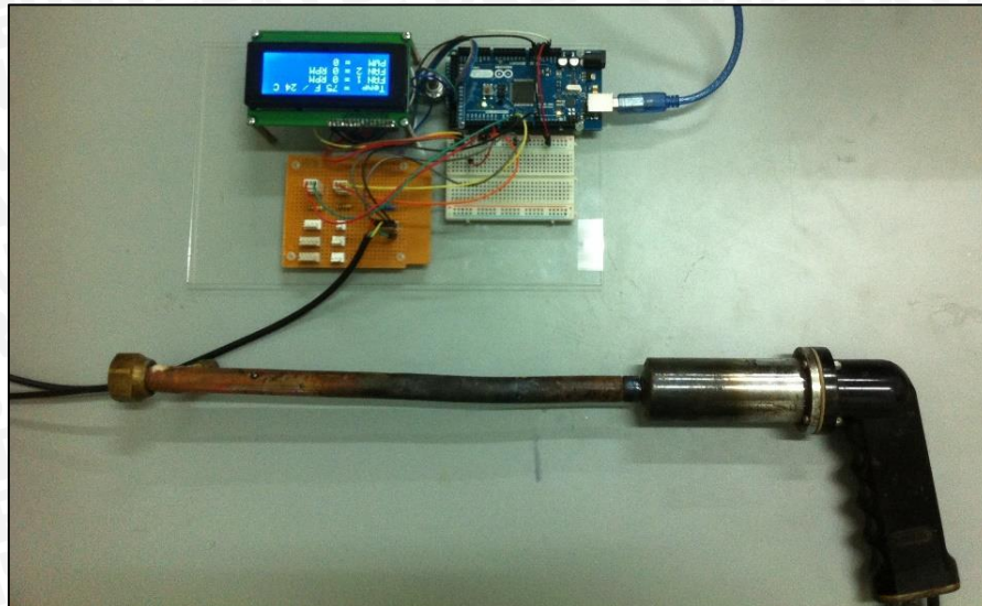
Gambar 5.3 Rangkaian Pengujian Hot Jet WA-51
