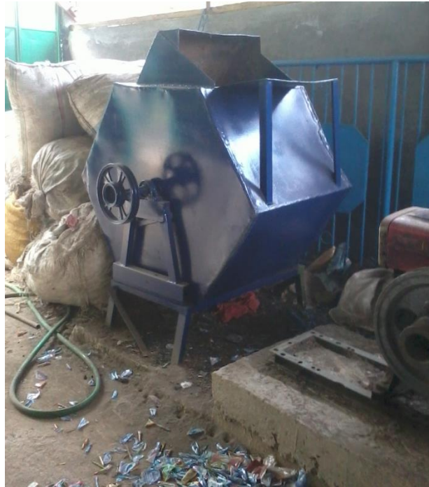
Gambar 4.7 Mesin Pemilah yang Digunakan untuk Memadatkan dan Mengeringkan Plastik Sumber: Hasil Survei 2014
