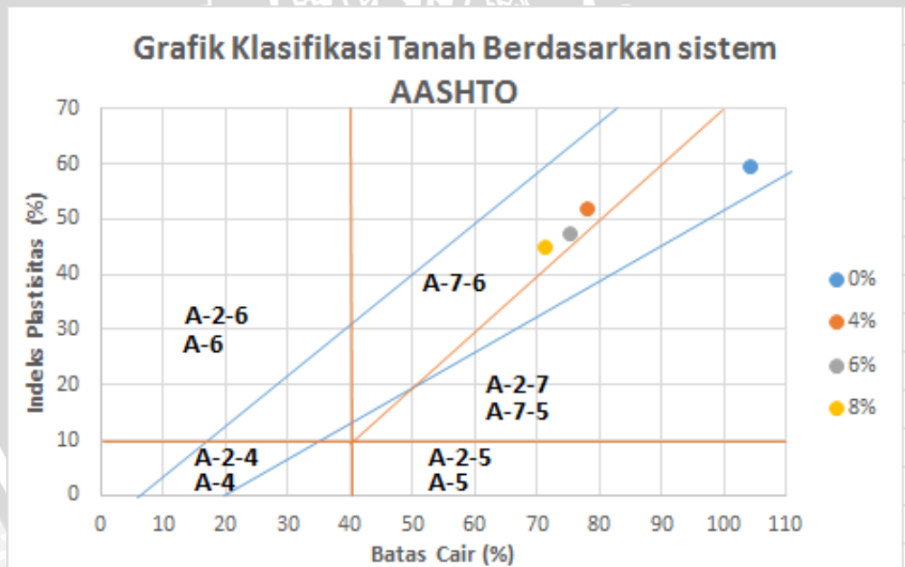
Gambar 4.4 Grafik Klasifikasi Tanah Berdasarkan Sistem AASHTO
