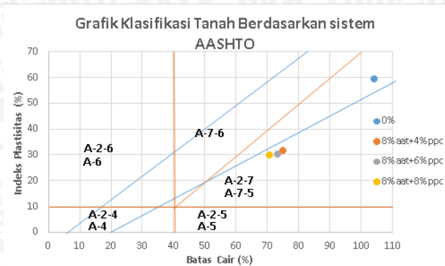
Gambar 4.3. Grafik Sistem Klasifikasi Tanah berdasarkan AASHTO
