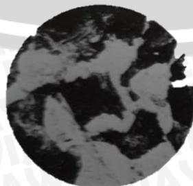
Gambar 2.12 Struktur *Medium-Carbon-Steel*. Pembesaran X 200
