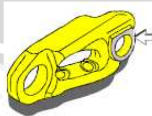
Gambar 4.7 Kerusakan pada sisi luar link
