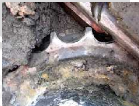
Gambar 4.11 Keausan pada teeth sprocket
