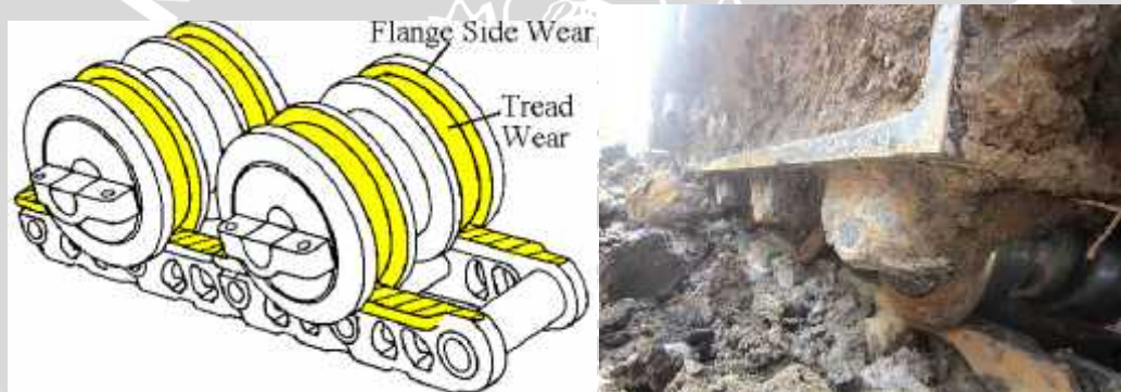
Gambar 4.14 Keausan pada flange track roller
