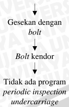
Gambar 4.10 Kerusakan pada lubang shoe bolt
