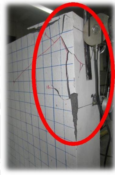
**Gambar 18. Kerusakan yang Terjadi Ketika Pemberian Beban Benda Uji C1**
