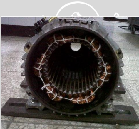
Foto Stator Motor Induksi Satu Fasa 2 Hp 8 kutub
