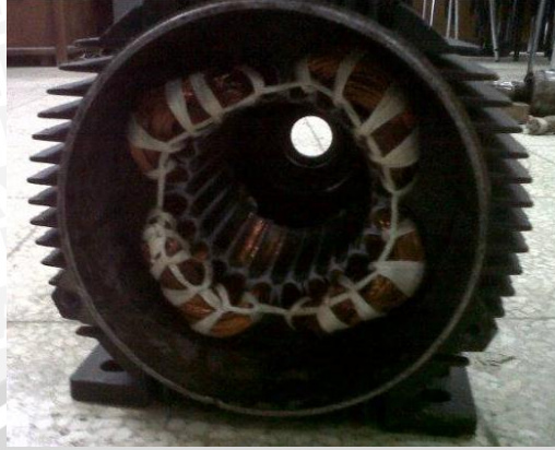
Foto Stator Motor Induksi Tiga Fasa 4kW 8 kutub
