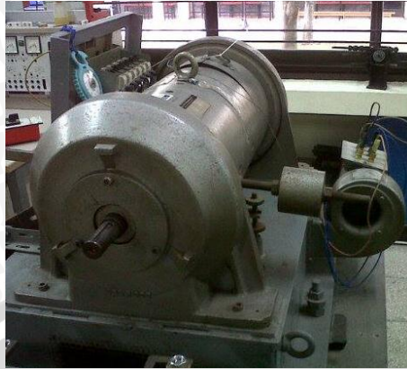
Foto Generator sebagai Beban Stator Motor Induksi untuk pengujian Berbeban
