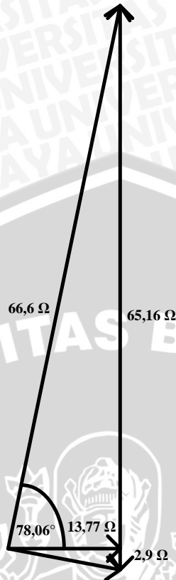
Gambar 5.7. Segitiga Impedansi untuk mendapatkan nilai kapasitor sebagai alat bantu starting motor induksi 1 fasa
