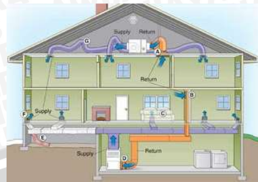
Gambar 2.14 Sistem air penuh menggunakan AHU Sumber: daikin-indonesia.blogspot.com
