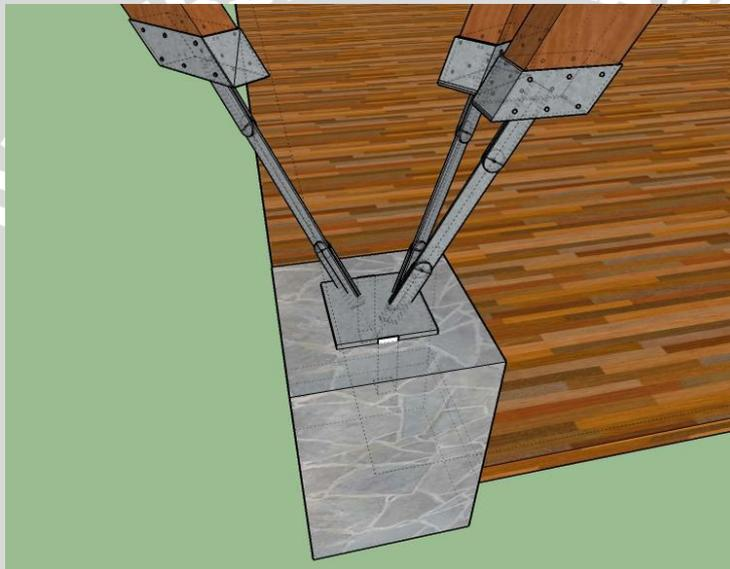
Gambar 4.58 Sambungan konstruksi kolom dengan balok cor.
