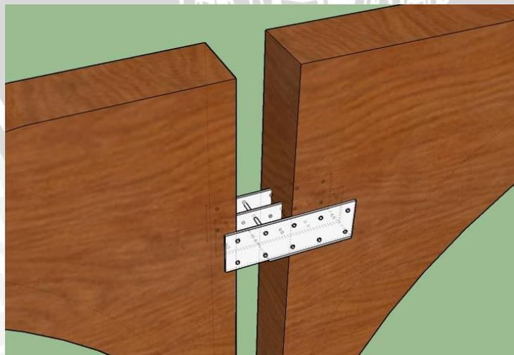
Gambar 4.59 Sambungan rangka kolom dengan balok.
