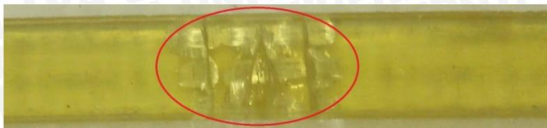
Gambar 4.6 Bentuk patahan spesimen dengan tension serat 40N.
