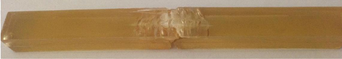
Gambar 4.8 Bentuk patahan spesimen uji impak dengan tension serat 0 N.
