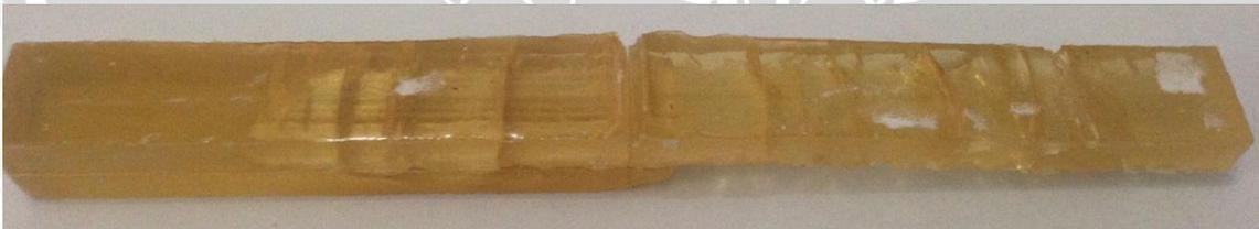
Gambar 4.11 Bentuk patahan spesimen uji impak dengan tension serat 30 N.
