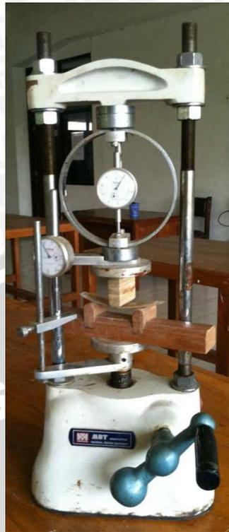
Gambar 3.3 Mesin uji lentur
