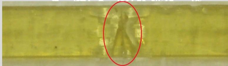
Gambar 4.4 Bentuk patahan spesimen dengan tension serat 20N.
