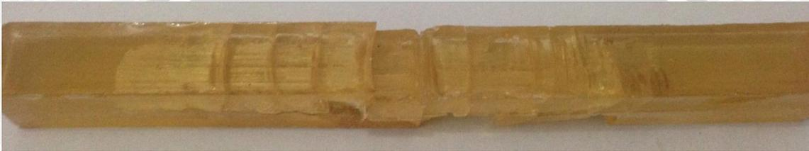
Gambar 4.9 Bentuk patahan spesimen uji impak dengan tension serat 10 N.
