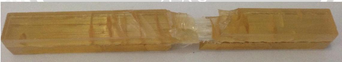
Gambar 4.12 Bentuk patahan spesimen uji impak dengan tension serat 40 N.
