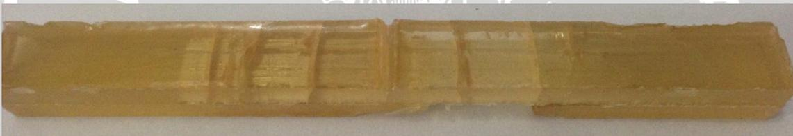
Gambar 4.10 Bentuk patahan spesimen uji impak dengan tension serat 20 N.
