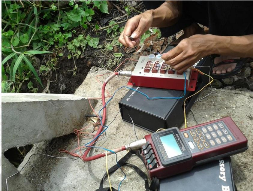
**Gambar 4.4** Pembacaan Regangan yang terjadi pada rangka
