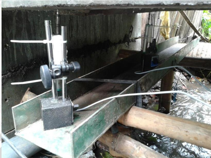
**Gambar 4.2** Perletakan LVDT pada pengujian lendutan
