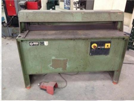
Gambar 3.7 Mesin Pemotong Plat
