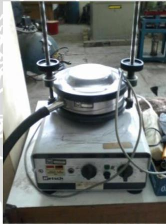
Gambar 3.11 Mesin Pengguncang Rotap
