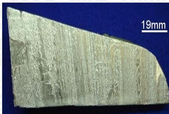
Gambar 2.6 Aluminium setelah dicetak dari tanur tanpa perlakuan Sumber: Anonymous 1 (2014)
