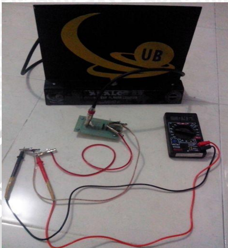
Gambar 5.17. Foto Pengujian Rangkaian Rectifier dengan Antena Planar Logo UB
