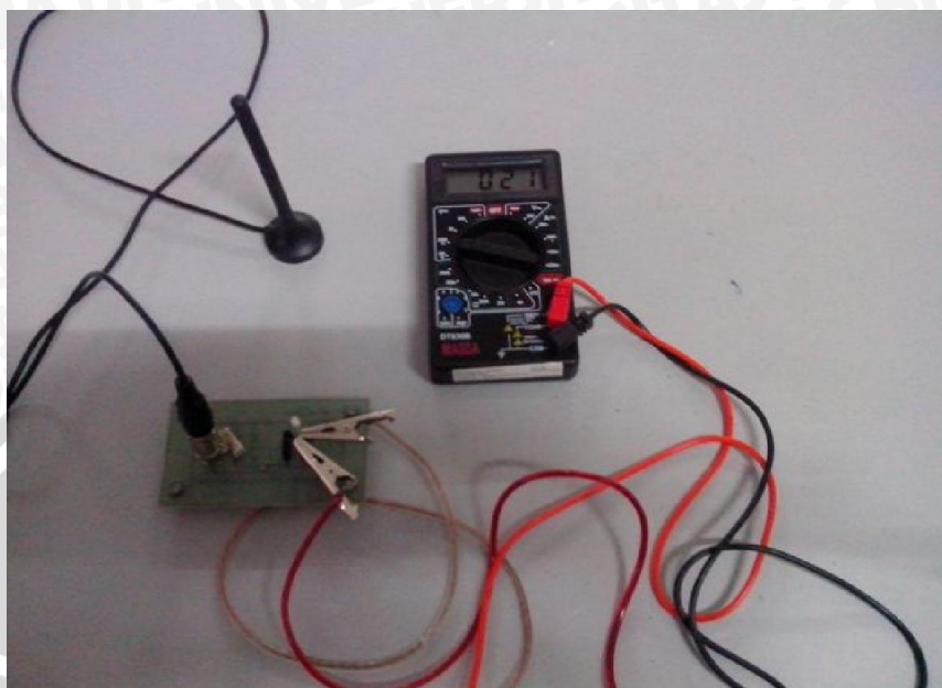
Gambar 5.3. Foto Pengujian Rangkaian Rectifier dengan Antena Indoor (Sumber: Pengujian)
