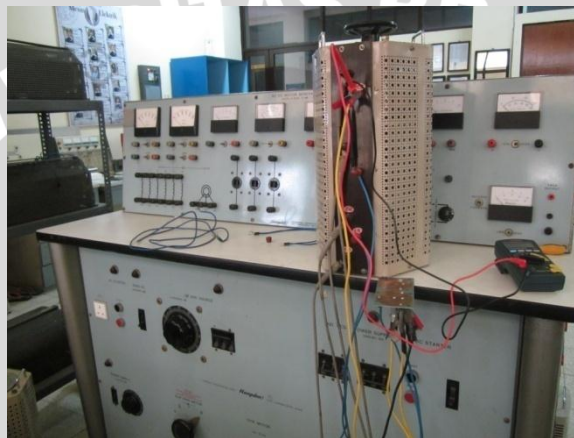
Foto pengujian arester PCB dengan menggunakan voltage regulator pada tegangan masukan 400 volt
