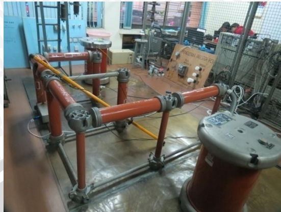
Foto rangkaian pengujian arester PCB
