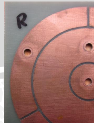
Foto rancang bangun arester PCB ( Printed Circuit Board ) untuk proteksi kWh meter tiga fasa setelah dilakukan pengujian
