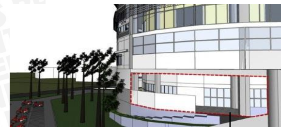
8 Pembentukan open plan melalui sistem panggung (bentukan tidak massif) pada lantai pertama massa 2 yang dihubungkan dengan suatu "pedestrian link bridge" untuk mencapai massa utama
