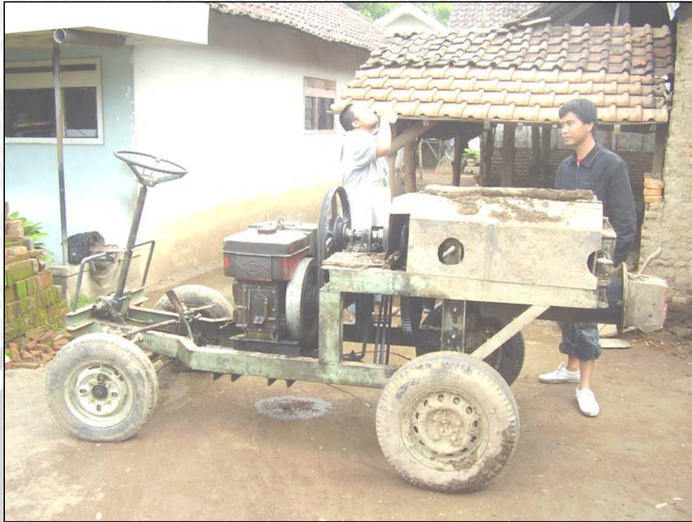
Mesin giling untuk bahan genteng mentah
