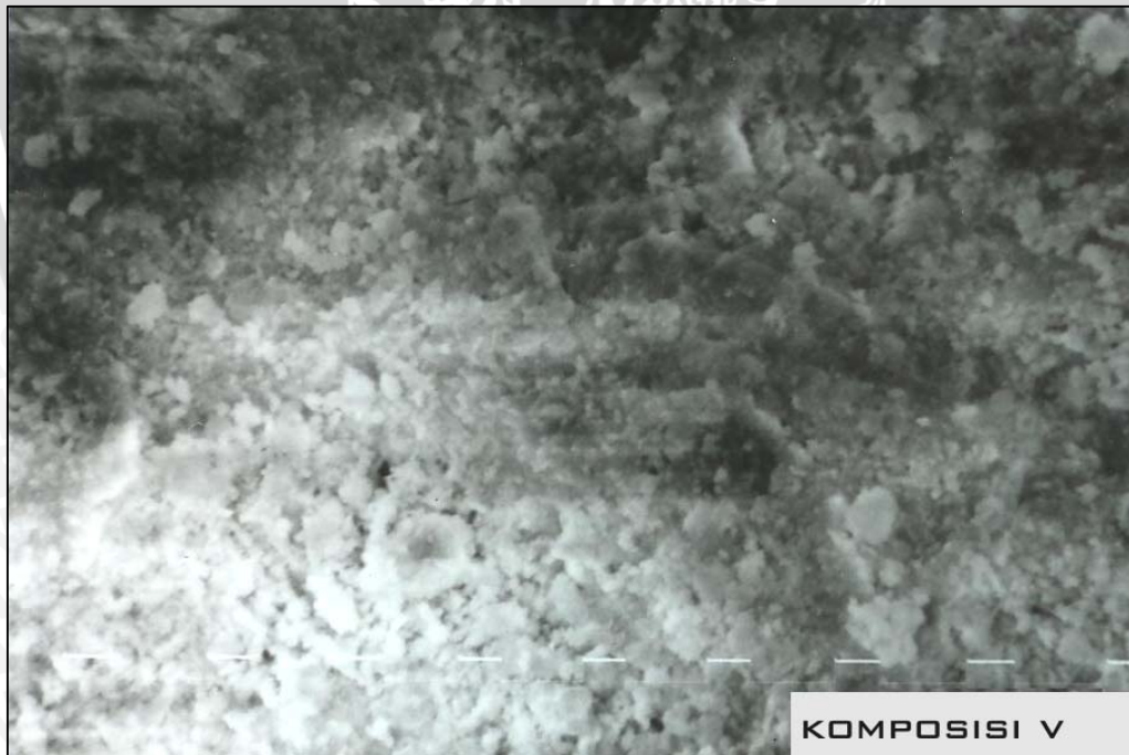
Gambar 4. 6 Foto Scanning Electron Genteng Komposisi V (70% Lumpur Lapindo + 30% Tanah Liat Asli)
