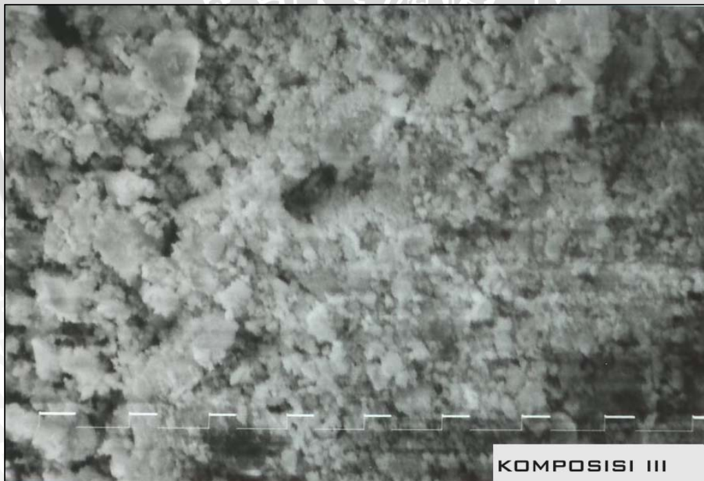
Gambar 4. 4 Foto Scanning Electron Genteng Komposisi III (60% Lumpur Lapindo + 40% Tanah Liat Asli)
