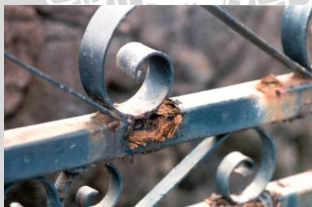
Gambar 2.1 Korosi kontak langsung logam dengan H_2O dan O_2
