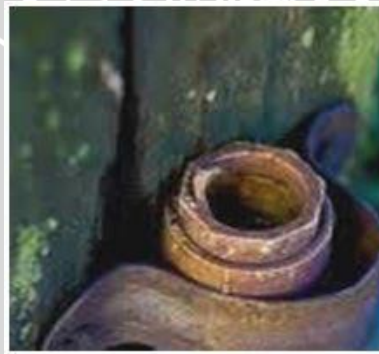
Gambar 2.6 Permukaan Logam yang Kasar Cenderung Mengalami Korosi
