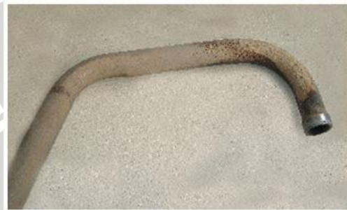
Gambar 2.4 Knalpot Kendaraan Bermotor yang Mudah Terkorosi Akibat Temperatur Tinggi
