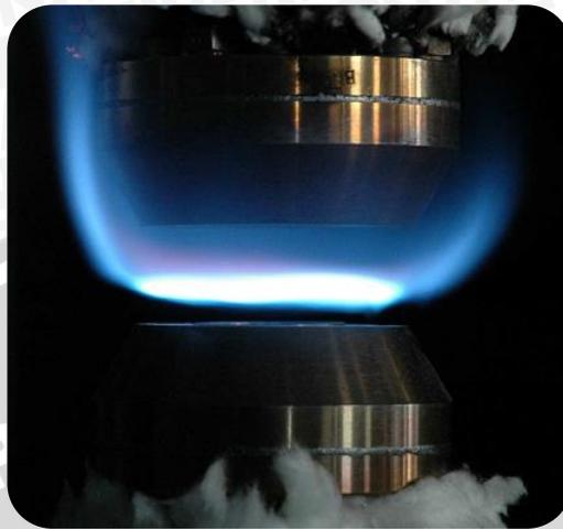
Gambar 2.7 Nyala api pada *counterflow burner*
