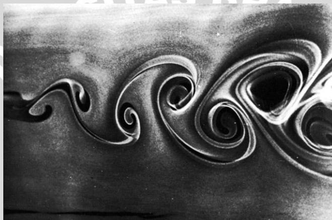
Gambar 2.12 Bentuk *vortex* setelah melewati silinder
