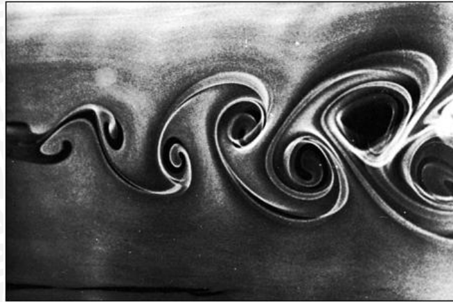
Gambar 2.13 Vortex di belakang silinder melingkar Sumber: White (1998)
