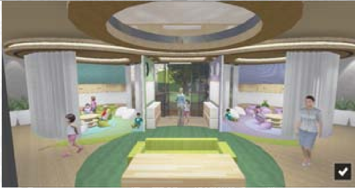
Skylight untuk pencahayaan alami dengan bukaan menggunakan bahan fiber semi transparent sehingga pencahayaan tidak langsung dan merata
