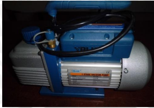
Gambar 3.10 Mesin vakum refrigeran Sumber : Laboratorium Mesin Pendingin Universitas Brawijaya
